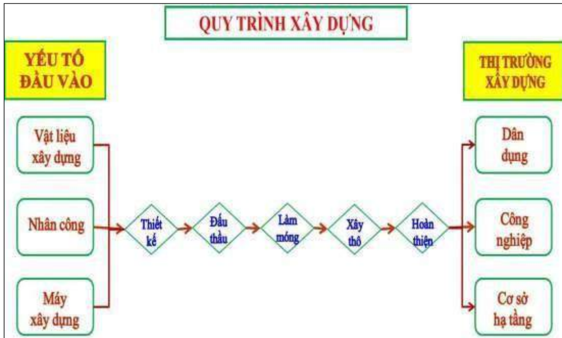
Hình 2.1: Quy trình xây dựng
